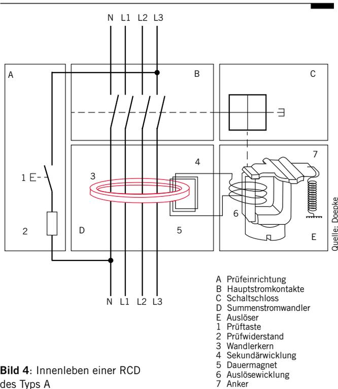
**Bild 4:** Innenleben einer RCD des Typs A
